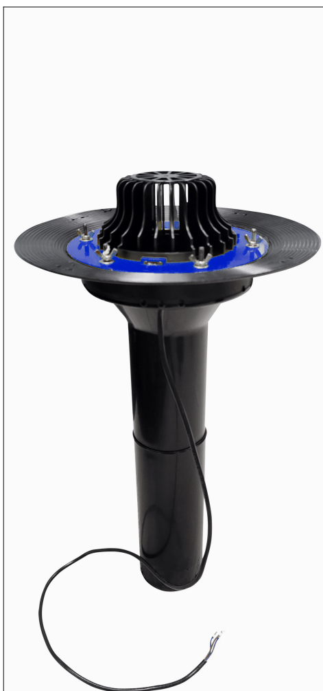
Рис.1. Воронка ТехноНИКОЛЬ Стандарт с прижимным фланцем и обогревом 110x590
