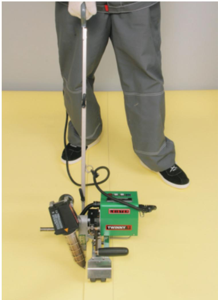
При подходе к концу нахлеста приведите рычаг зажима в крайнее верхнее положение. Выньте сопло аппарата из нахлеста, слегка потянув его в сторону по направляющей. Остановите движение ведущих роликов нажатием кнопки «М».
