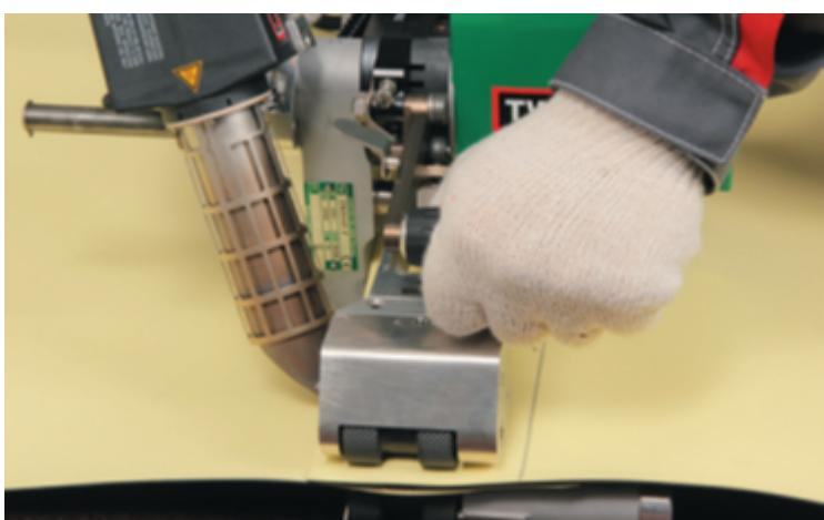
Приведите в действие ведущие прижимные ролики нажатием кнопки «М». Следите за направлением движения аппарата, при необходимости корректируйте его при помощи рукоятки.
