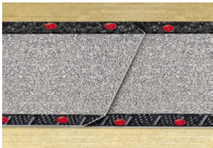
**Важно! Во избежание противошовки соблюдайте правильный нахлест торцевого шва. Вода должна стекать со шва в сторону водоприёмной воронки:**
