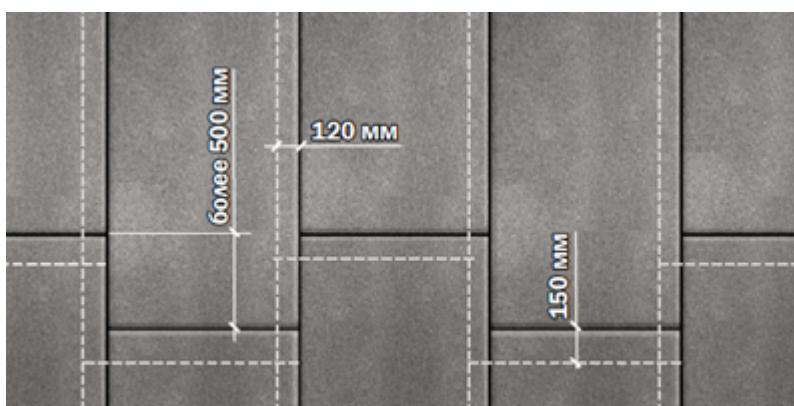
В традиционном решении рулоны укладываются параллельно друг другу с формированием торцевых (нахлест не менее 150 мм) и боковых швов (нахлест не менее 120 мм).
