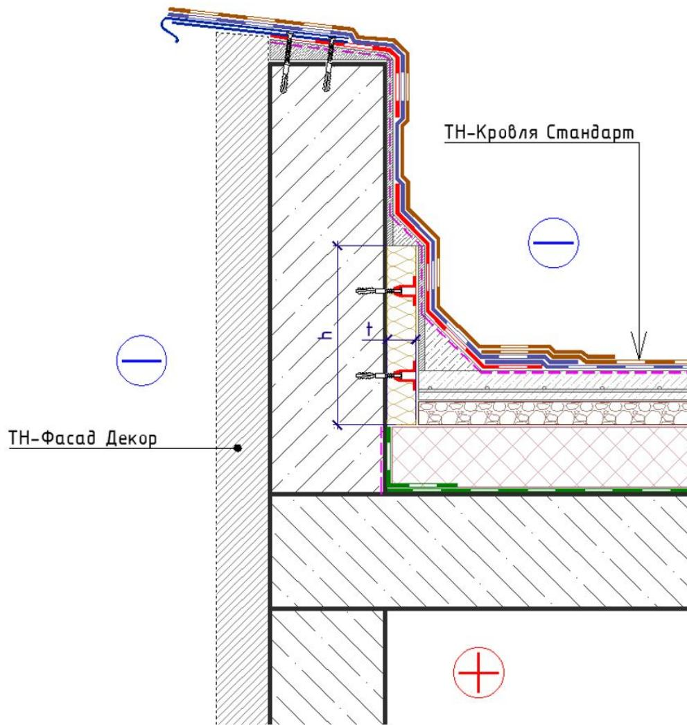
Расчет показывает, что минимальная температура на внутренней поверхности узла составляет +13,2 °C, что соответствует санитарно-гигиеническим требованиям.
