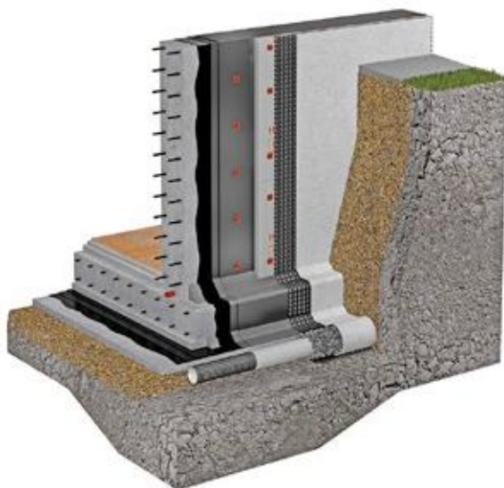
Рисунок 2.10. – Система ТН-ФУНДАМЕНТ Дренаж
