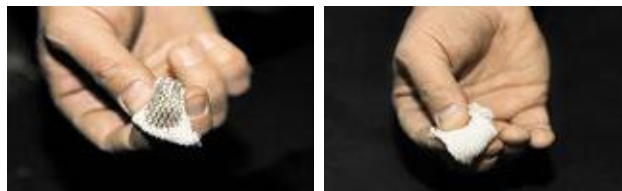
Рисунок 3.8. – Определение высыхания праймера
