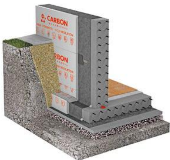
Рисунок 2.9. – Система ТН-ФУНДАМЕНТ Термо
