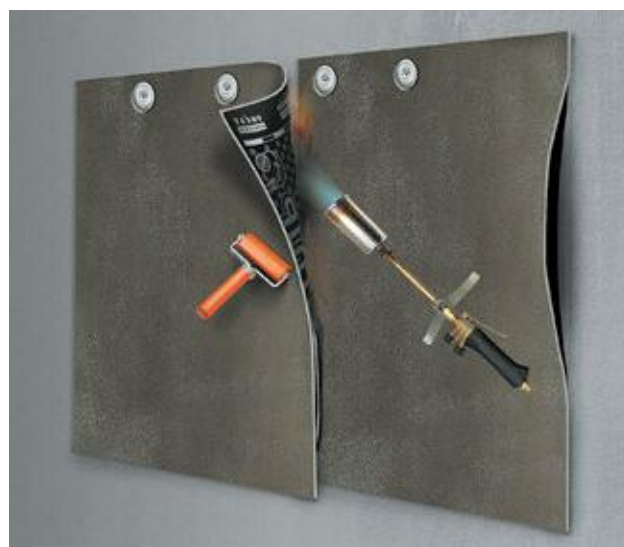
Рисунок 5.5. – Механическая фиксация рулона с последующей сваркой нахлестов
