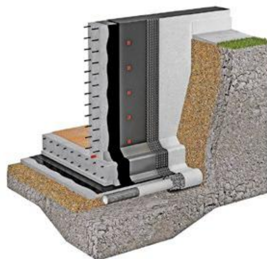
Рисунок 2.8. – Система ТН-ФУНДАМЕНТ Дренаж Лайт
