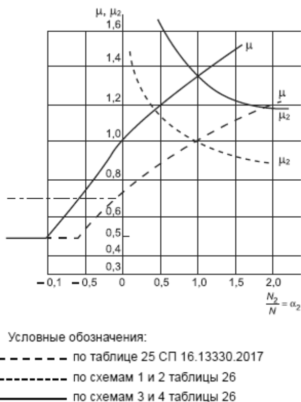
Рисунок 16 - График для определения значений коэффициентов расчетных длин пересекающихся стержней (при равных длинах и жесткостях) при различных усилиях в них
