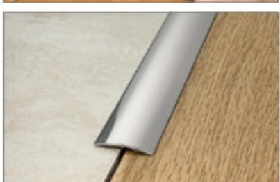
— Пристыковка покрытий из разнородных материалов рекомендуется установка медных алюминиевых или стальных элементов, защищающих края этих покрытий от механических повреждений, попадания воды в шов и отклеивания. Для паркетных и плиточных покрытий полов такие элементы, кроме того, позволяют компенсировать деформации от температурно-влажностных воздействий.
