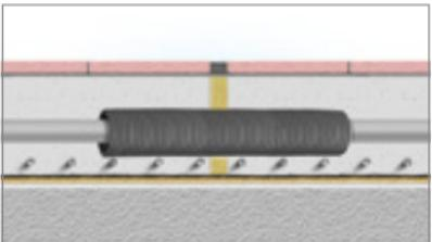
— Трубы при прохождении через шов должны быть предохранены гофрированной оболочкой длиной 30–40 см или должны иметь защитную оболочку длиной не менее 1 м в соответствии с СП 41-102-98.
