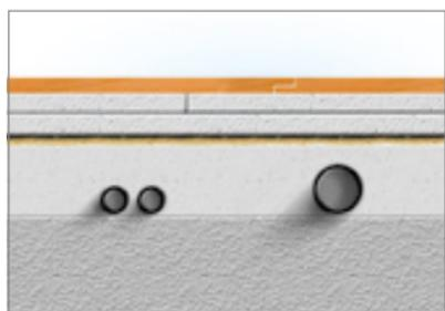
— Перед началом работ по устройству полов со сборными стяжками завершите все работы, связанные с производством электромонтажных и санитарно-технических, а также всех строительных работ, связанных с «мокрыми» процессами.
