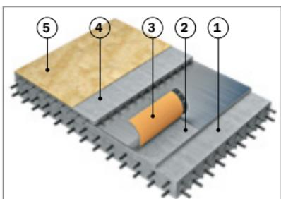
1. – Железобетонная плита перекрытия;
