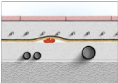
**! ВАЖНО!** Очистка и выравнивание поверхности позволяют избежать повреждения звукоизоляционного полотна и появления звуковых мостиков.
