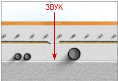
**! ВАЖНО!** Проклейка лентой-герметиком предохранит уложенные материалы от смещения при последующем монтаже напольного покрытия и от образования звуковых мостиков вследствие возможного попадания цементно-песчаного раствора в боковые и торцевые стыки соседних полотнищ.
