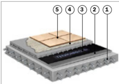
1. – Железобетонная плита перекрытия;
