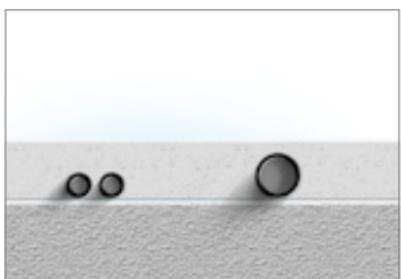
— Дополнительный выравнивающий слой должен быть выполнен из монолитной стяжки из бетона класса не ниже В12,5 или из цементно-песчаных растворов на основе смесей сухих строительных напольных на цементном вяжущем с прочностью на сжатие не ниже 15 МПа.
