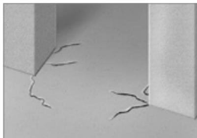
— Устройство температурных и деформационных швов позволяет избежать появления трещин в монолитных стяжках, вызванных расширением/сжатием стяжки из-за температурных перепадов и деформационными явлениями несущих конструкций в процессе эксплуатации.
