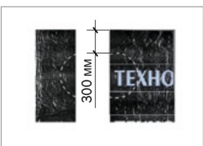
— Подготовьте дополнительные заплатки из материала для герметизации заготовки на горизонтальной поверхности:
