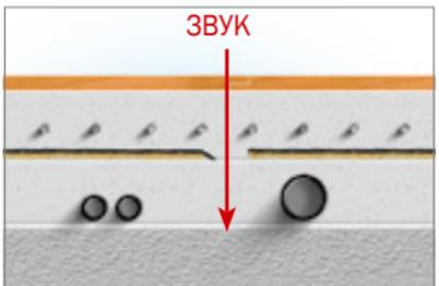
**! ВАЖНО!** Очень важно состыковать материал, так чтобы звукоизоляционный материал оказался на всей плоскости перекрытия. Если этого не делать, то в конструкции будут образовываться звуковые мостики, через которые будет распространяться шум.
