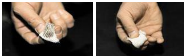
Рисунок 3.8. – Определение высыхания праймера
