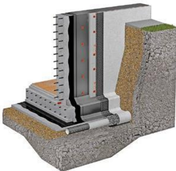
Рисунок 2.10. – Система ТН-ФУНДАМЕНТ Дренаж
