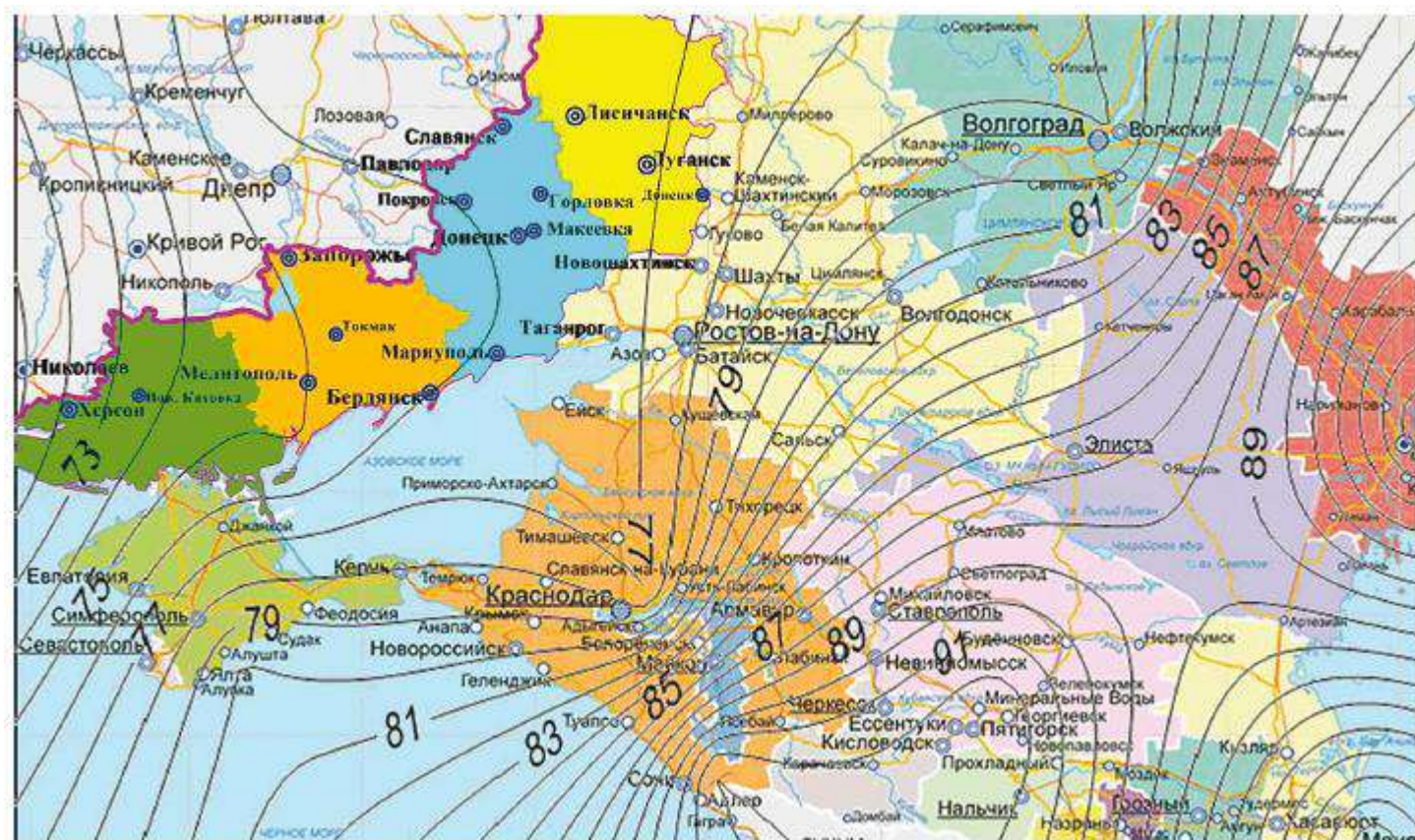
Рисунок 13 - Карта изолиний среднечасовой суммарной солнечной радиации для южного фасада в отопительный период, Вт/м 2
