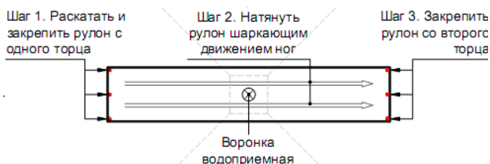
Рисунок 4.2 – Укладка первого рулона гидроизоляционного материала
