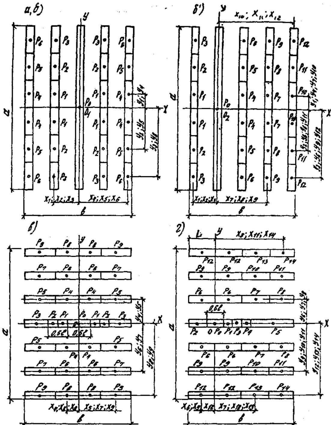
*a, b* - нагрузки, равномерно распределенные по длине параллельных следов (от прокладок под тяжелые предметы, от штабелей цилиндрических валов и др.) при  $b \leq 4,4l$ ;  $a > b$ ; *b', c* - то же, при  $b > 4,4l$ ;  $a > b$
