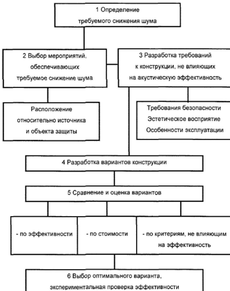
Рисунок 7.3 - Основные этапы проектирования шумозащитных мероприятий
