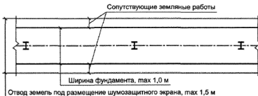
Рисунок 8.3 - Схема определения габаритных размеров отвода земель под шумозащитный экран
