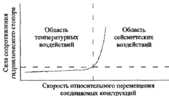
Рисунок А.9 - Схема работы гидравлического стопора
