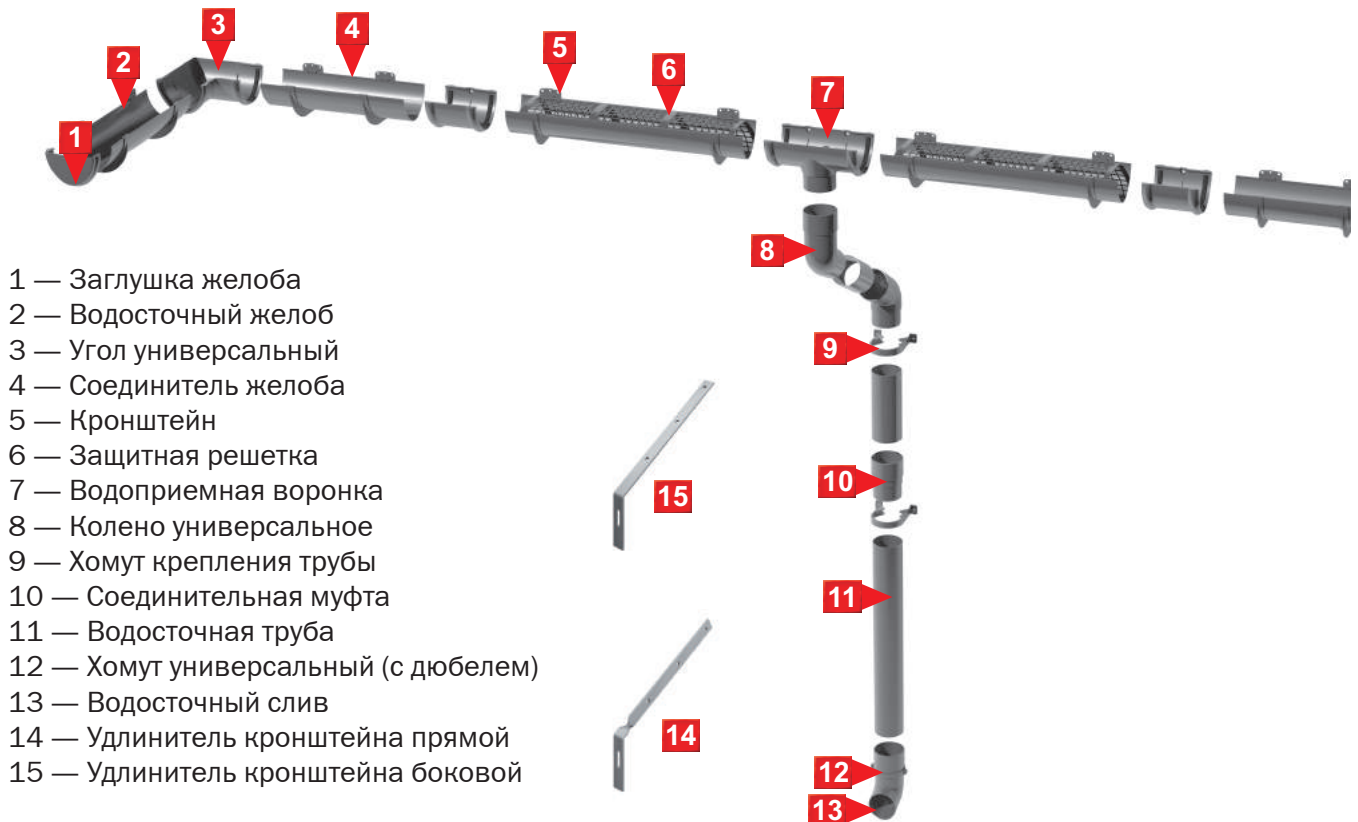
Рисунок Л.1 — Элементы пластиковой водосточной системы ТЕХНОНИКОЛЬ
