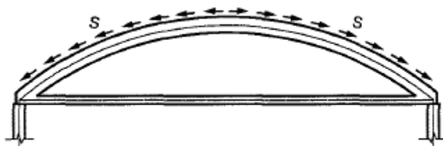
Рисунок 9.8 - Схема передачи усилий с оболочки на диафрагму
