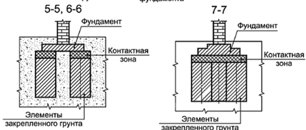
а), б) - сплошное из рядом расположенных элементов; в), г) - отдельно стоящих элементов; д), е), ж) - отдельно расположенных рядов сплошных элементов; и) - сплошное с расположением элементов по сетке квадрата
