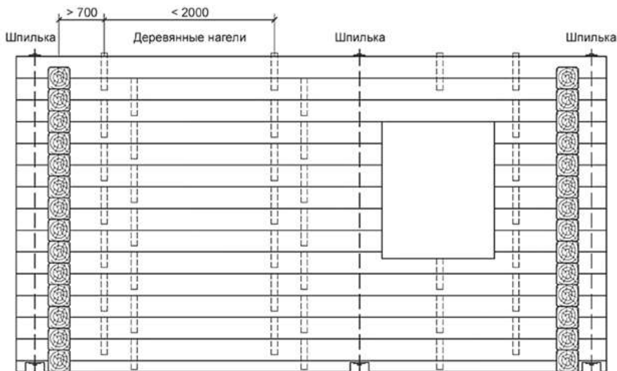
Рисунок 5.1а - Пример прошивки срубной стены
