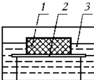
1 - образец; 2- сетчатая подставка; 3 - ванна с водой
