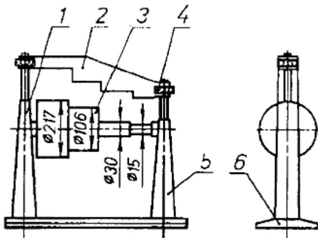
1 - опора; 2 - прижимная планка; 3 - цилиндр; 4 - гайка; 5 - опора; 6 - основание
