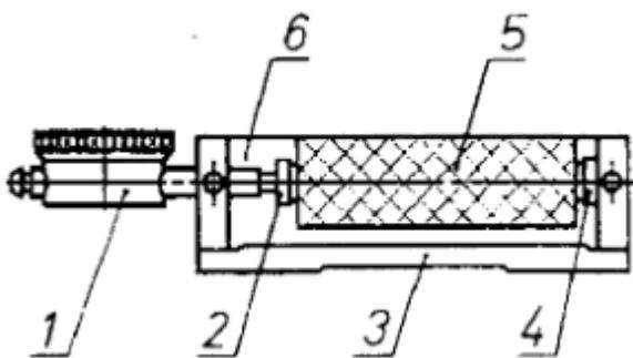
1 - индикатор часового типа; 2 - наконечник измерительного стержня индикатора;
