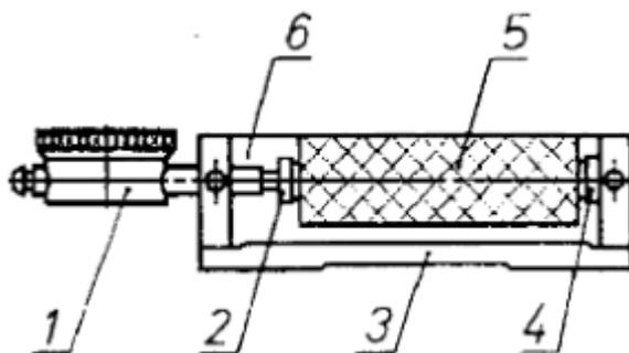
1 - индикатор часового типа; 2 - наконечник измерительного стержня индикатора;
