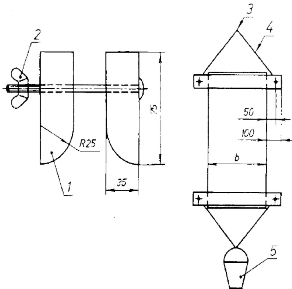
1 - зажим; 2 - крыльчатая гайка; 3 - точка подвеса; 4 - веревка;
