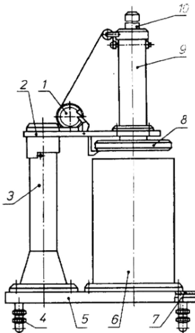
1 - храповик; 2 - кронштейн; 3 - колонна; 4 - установочный винт; 5 - основание;
