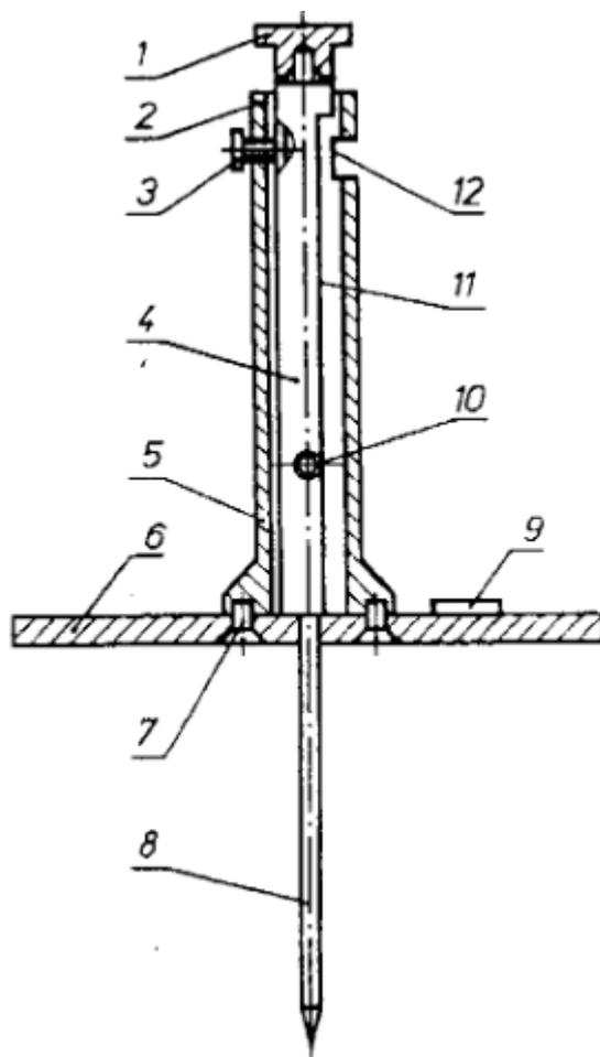
1 - ручка; 2 - втулка; 3 - зажимной винт; 4 - вставка; 5 - корпус; 6 - основание;
