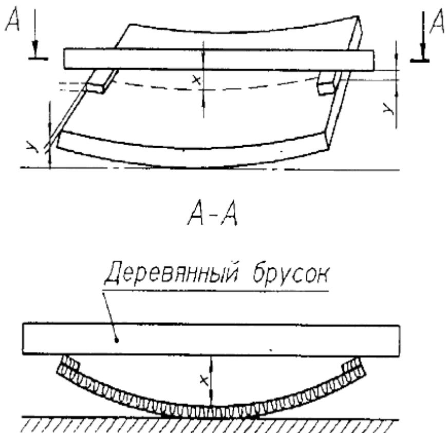
Рисунок Б.3 - Измерение отклонения от плоскостности плиты
