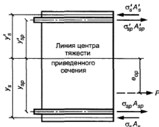
Рисунок 9.1 - Схема усилий предварительного напряжения в арматуре в поперечном сечении железобетонного элемента
