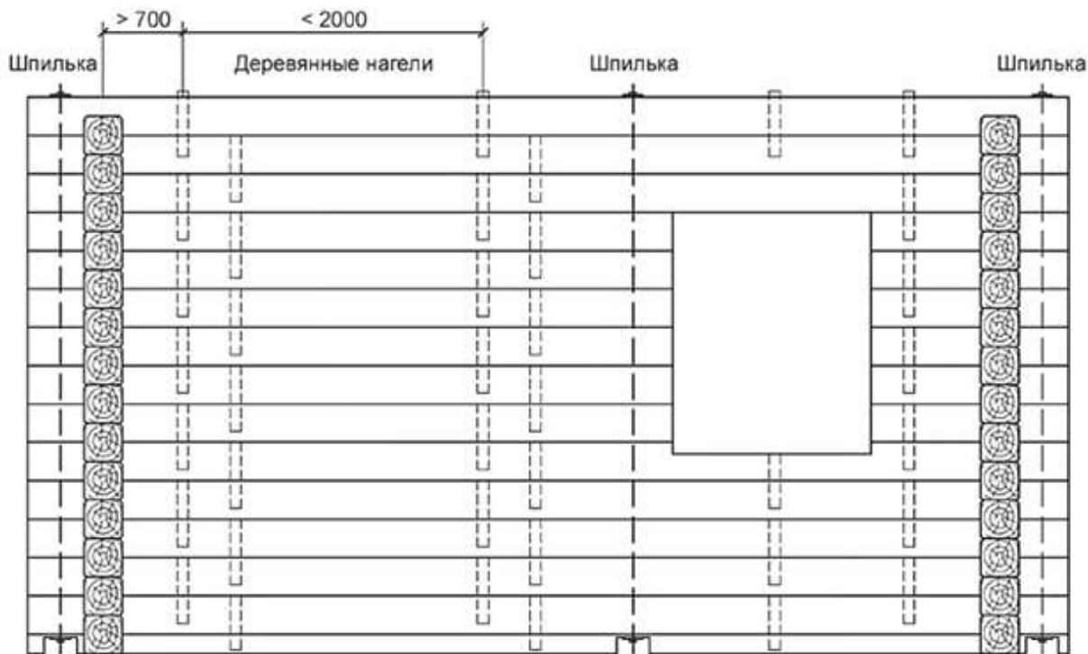
Рисунок 5.1а - Пример прошивки срубной стены
