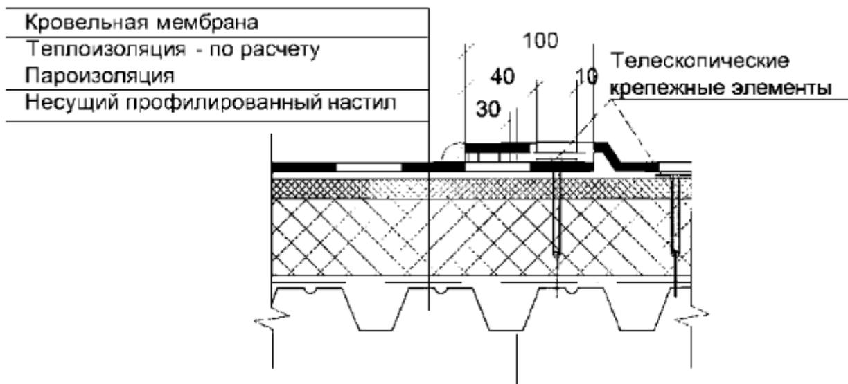
Рисунок 3 - Механическое крепление мембраны, уложенной на утеплитель
