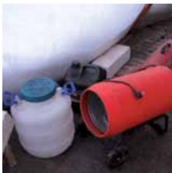
Выполнение работ в зимнее время года допускается при условии соблюдения дополнительных мер по обеспечению требуемых температурного и влажностного режимов. При проведении монтажных работ зимой необходимо закрывать строительные леса одним или двумя слоями пленки по всему периметру здания и устанавливать тепловые пушки
