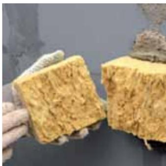
Если разрыв произошел по утеплителю, значит, несущей способности основания достаточно для монтажа системы.
