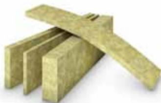
Ламели ТЕХНОФАС Л — полосы, нарезанные из негорючих, гидрофобизированных тепло-, звукоизоляционных плит на синтетическом связующем, изготовленных из каменной ваты на основе горных пород базальтовой группы. Волокна в ламели
